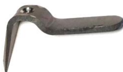
Рис. 1 - Z –образный изгиб пластин-имплантатов из биомедицинского титана
